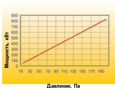
На диаграмме приведена типовая зависимость потребляемой мощности от величины перепада давления.
